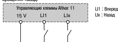
Схема подключения двухпроводного управления
